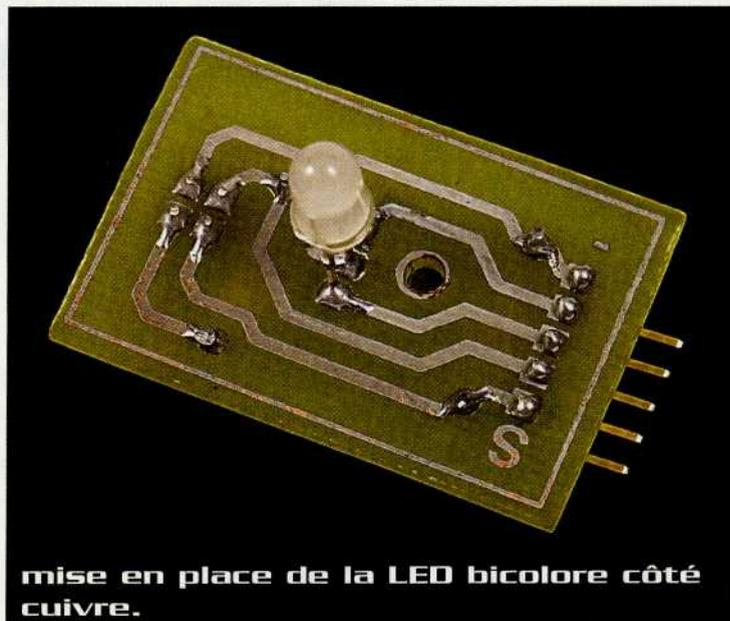
mise en place de la LED bicolore côté cuivre.
